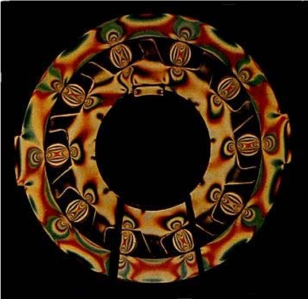
Abbildung 44 – Spannungsoptisches Schaubild eines Klemmrollenfreilaufs [10]
