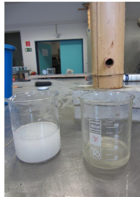
Abb.4.43: Untersuchung Bambus, Vergleich das Wasser vor und nach dem Filtern
