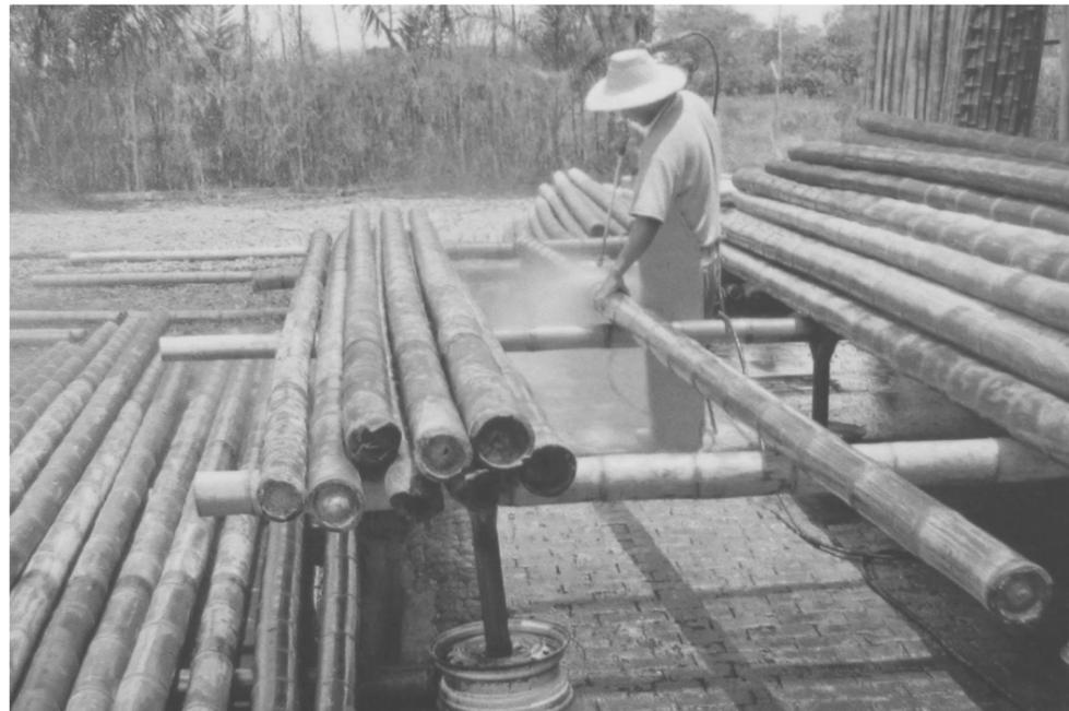
Abb.4.34: Reinigung der Oberfläche
