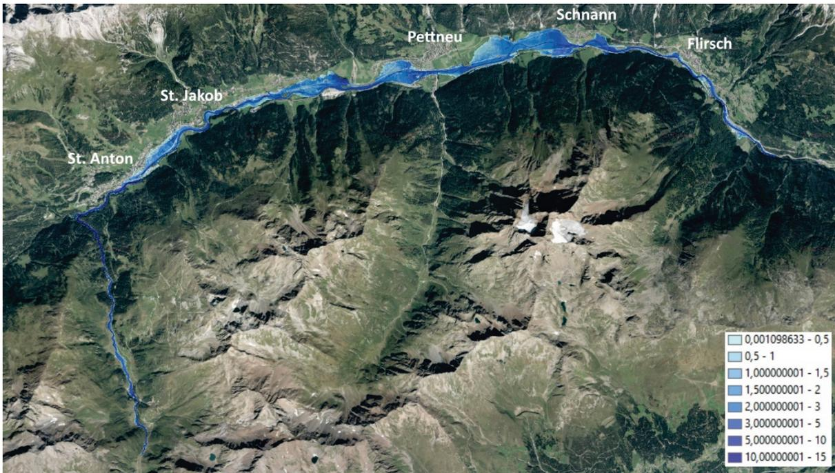
Abb. 4.11: Maximale Wasserstände Flutwelle Pierce<sup>266</sup>
