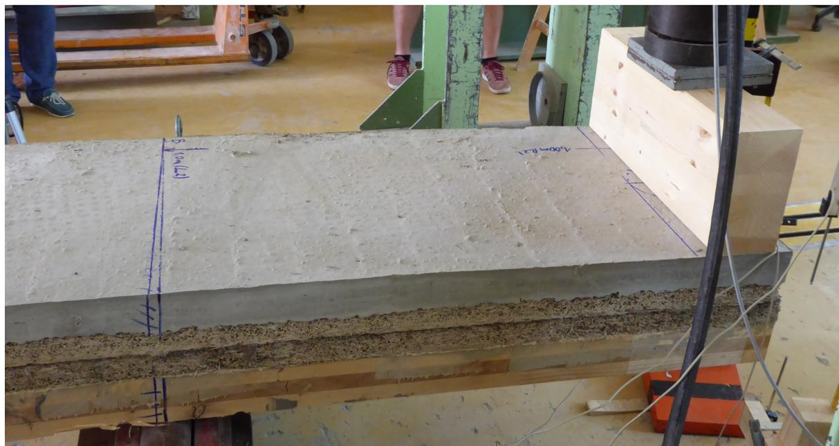
**Abb. 6.10:** Druckversuch - CLT-1 bis CLT-3
