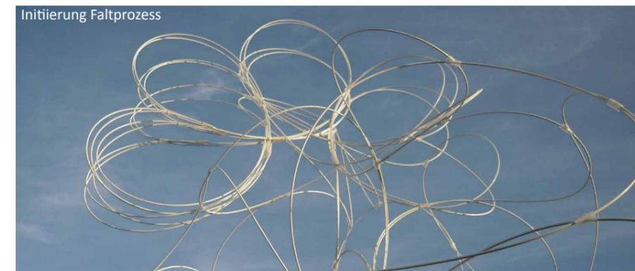
Kreuzungsgeometrie mit vertikaler Knotenrichtung unkomprimiert
