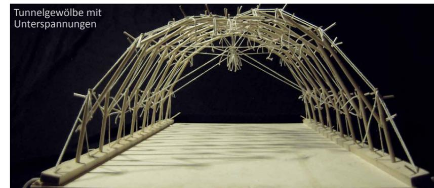
Tunnelgewölbe mit Unterspannungen
