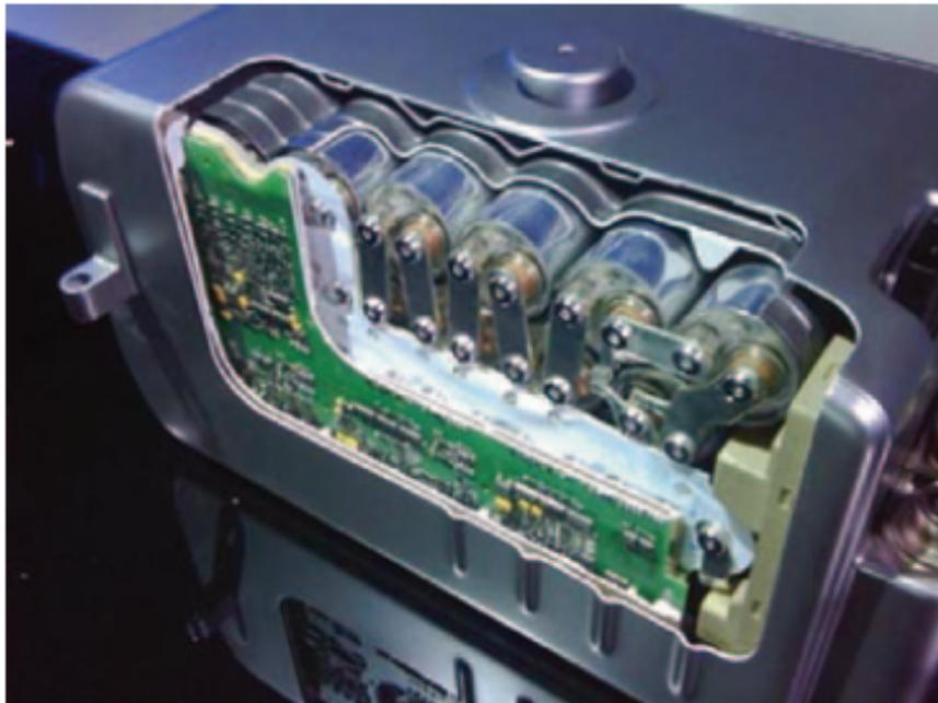
**Abbildung 4.1:** Blockförmiger Aufbau eines Lithium-Ionen-Batteriesystems (Daimler S400 Hybrid)
