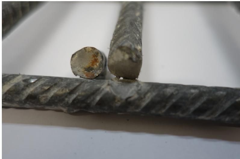
Abbildung B.2.3.: Ermüdungsbruch an einem Bewehrungsstab mit Heftschweißung bei Versuchskörper 2
