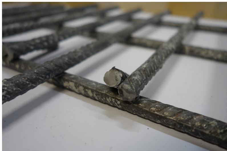
Abbildung 7.3.4.: Ermüdungsbruch an einem Bewehrungsstab mit Heftscheifung bei Versuchskörper 8
