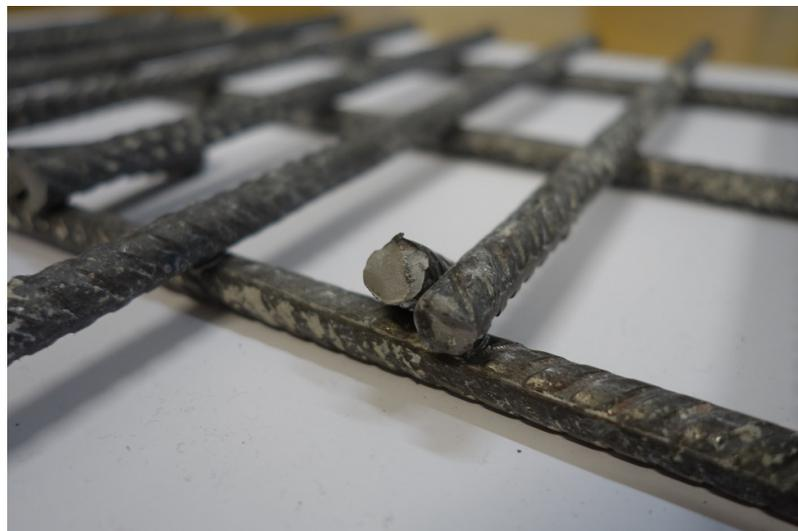
Abbildung B.8.4.: Ermüdungsbruch an einem Bewehrungsstab mit Heftschweißung bei Versuchskörper 8
