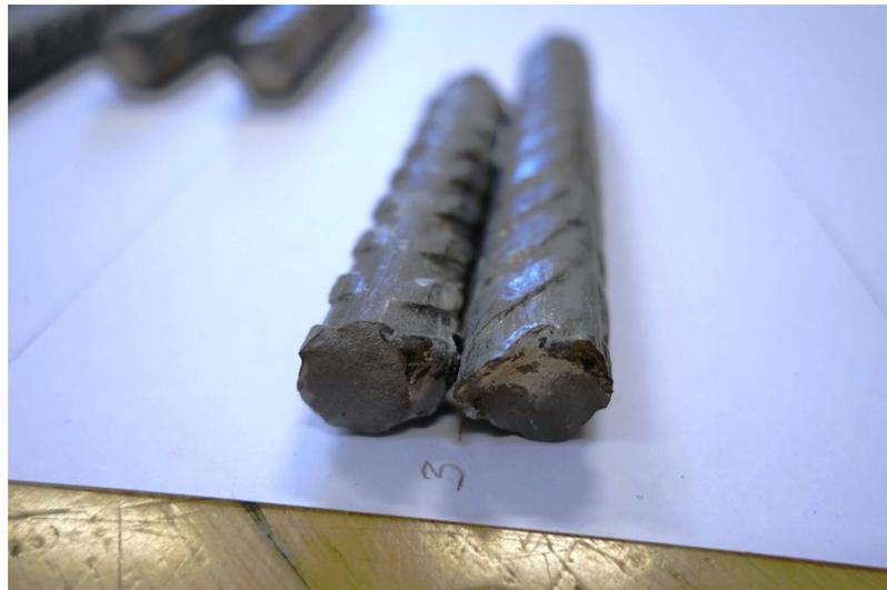
Abbildung B.4.5.: Ermüdungsbruch an einem Bewehrungsstab bei Versuchskörper 4
