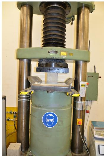
Abbildung 7.1.1.: Prüfmaschine für Druckversuche
