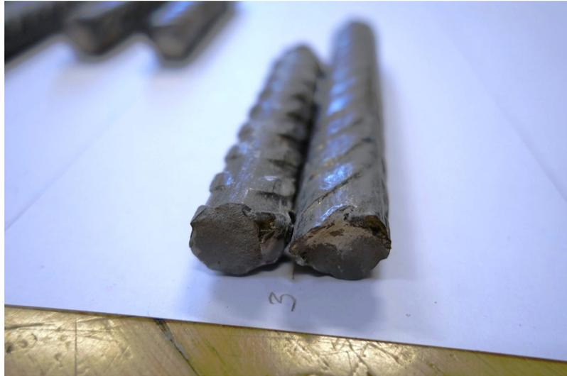
Abbildung 7.3.9.: Ermüdungsbruch an einem Bewehrungsstab bei Versuchskörper 4
