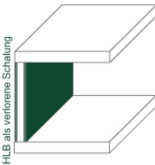
Abbildung 14: Holzleichtbeton als verlorene Schalung
