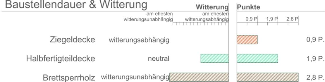
Abbildung 207: I2 Herstellung und Baustelle: Witterung
