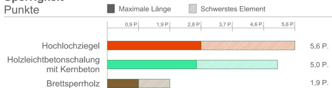
Abbildung 149: I2 Herstellung und Baustelle: Sperrigkeit
