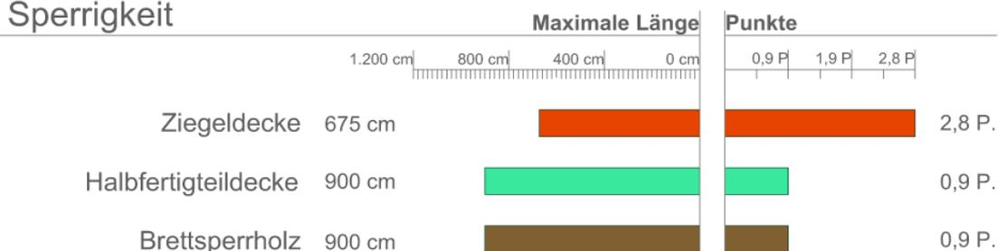
Abbildung 203: I2 Herstellung und Baustelle: Sperrigkeit maximale Länge
