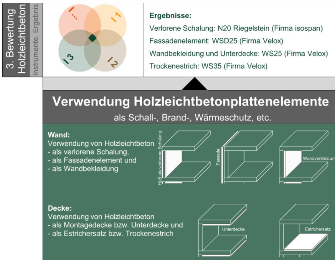
Abbildung 262: Übersicht Holzleichtbeton
