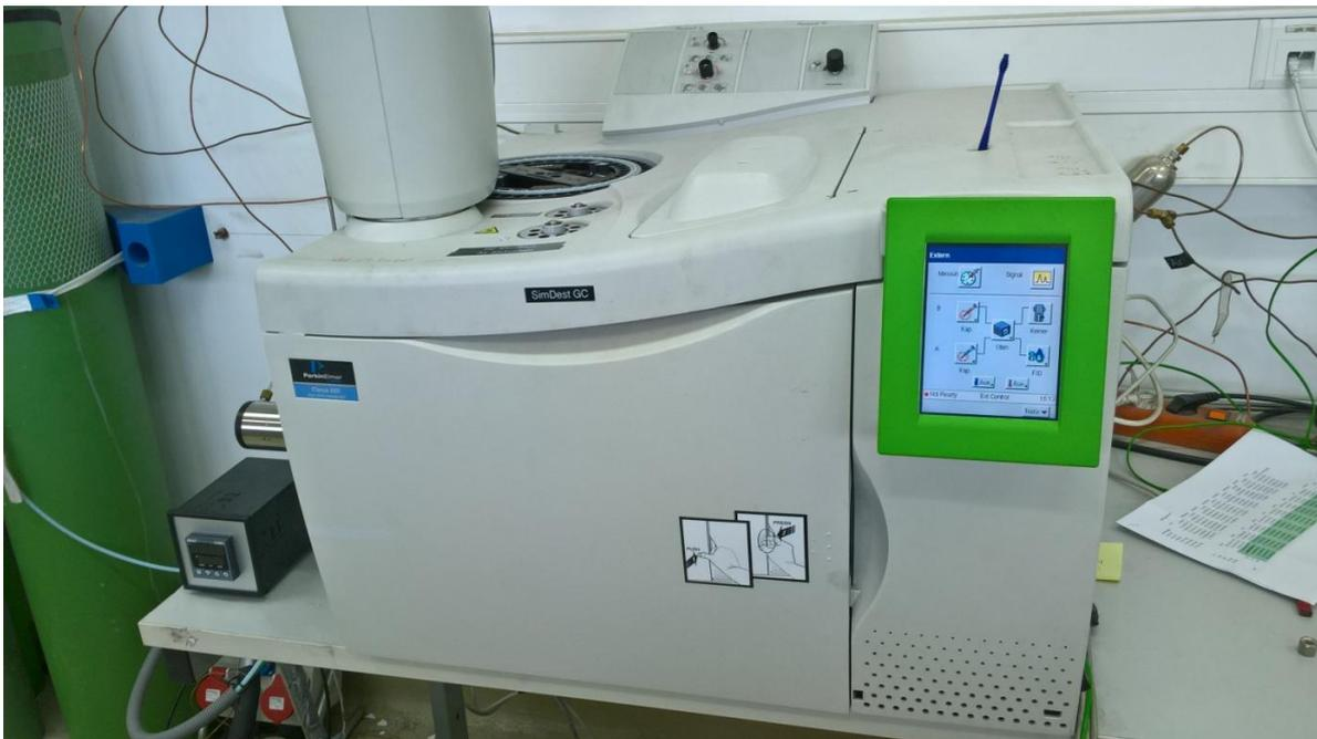
Abbildung 4.4-1 Teerkomponenten-GC (Perkin Elmer Clarus 500 GC)
