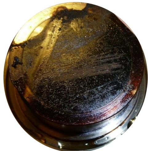
Abbildung 52: Verschmutztes Sichtzellenglas
