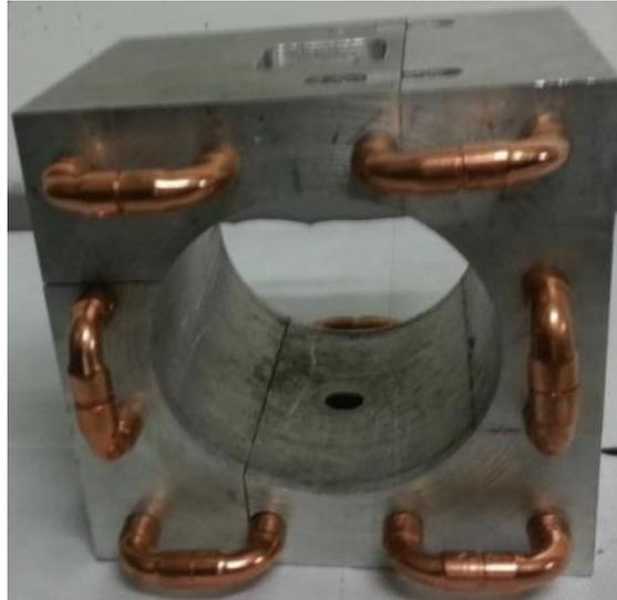
Abbildung 35: Beheizbarer Aluminiumblock<sup>99</sup>
