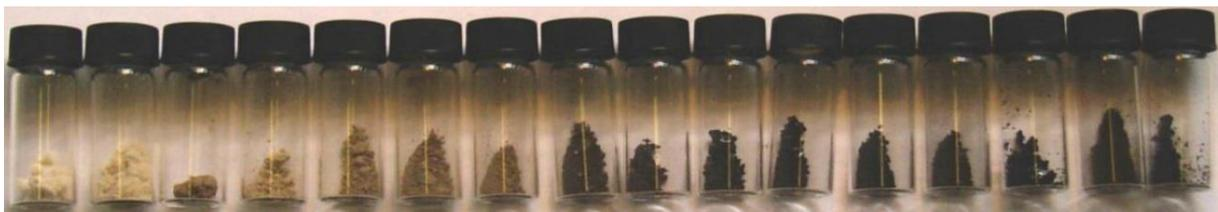
Abbildung 32: Farbe nach der HTC von Cellulose bei 200 °C mit Reaktionszeiten zwischen 1 bis 65 h<sup>97</sup>
