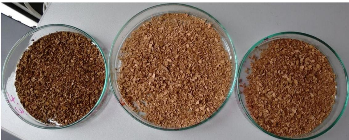
Abbildung 72: Holzspäne nach der HTC und Trocknung (v.l.n.r. 1 h bei 200 °C, 1 h bei 180 °C, 3 h bei 180 °C)
