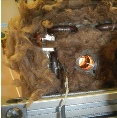
Abbildung 42: Frontansicht des Reaktors mit Wärmeisolierung und Temperatursensor
