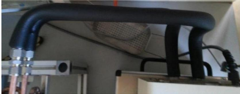
Abbildung 38: Verbindung zwischen Haake Badgefäß B12 und Aluminiumblock<sup>109</sup>
