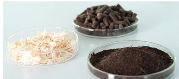
Abbildung 1: Carbonisierung von Holzspänen<sup>6</sup>
