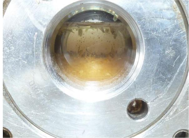
Abbildung 54: Sichtzelle mit Lampe vor dem Reaktor
