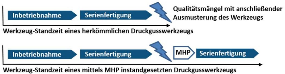
Abbildung 46: Prozesskettenvergleich des herkömmlichen und aufbereiteten Werkzeugs
