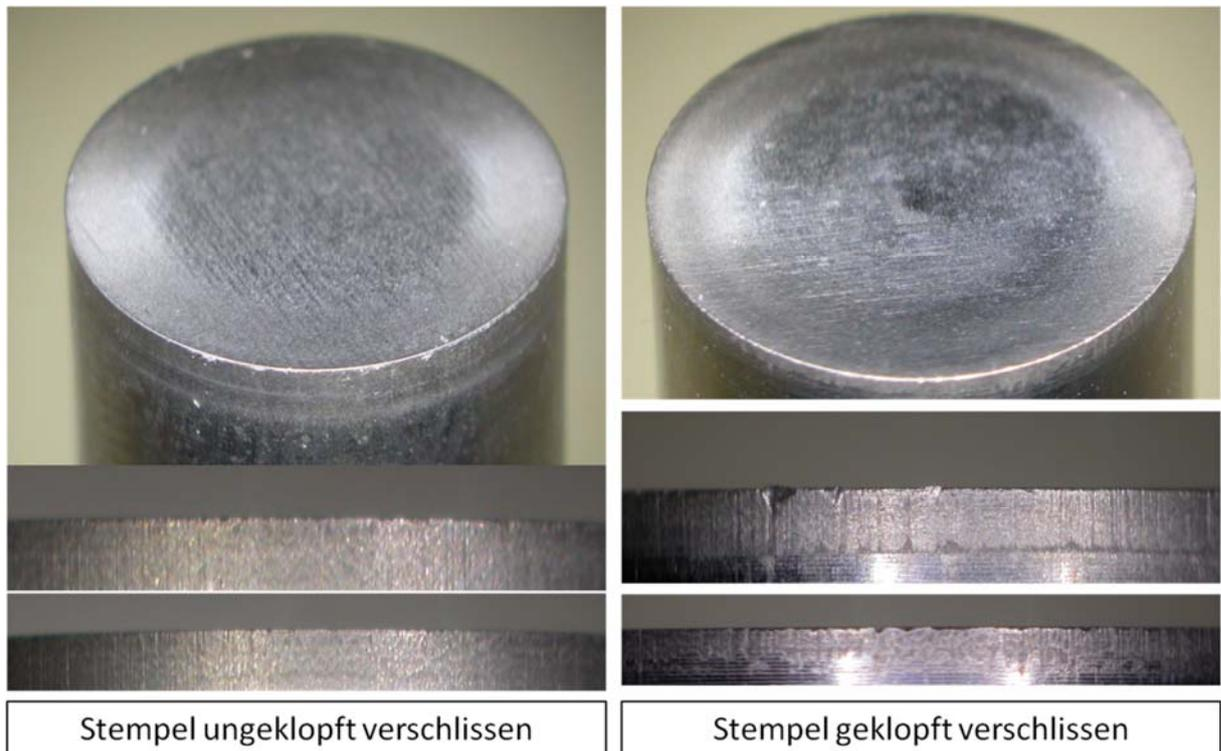
*Abbildung 41: Vergleich der Kanten mittels Mikroskopaufnahmen*
