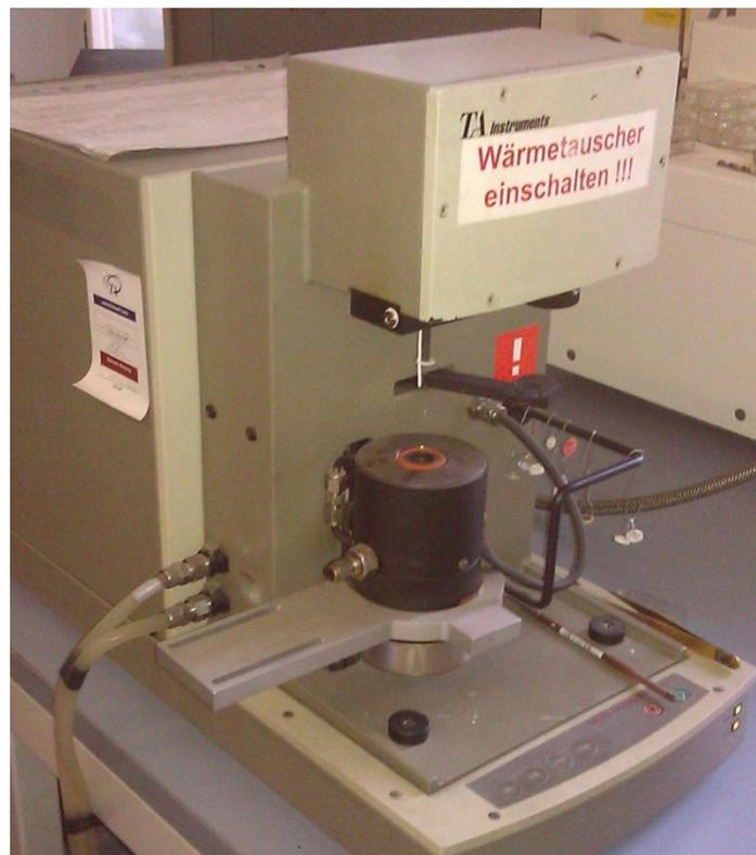
Abbildung 24 Thermogravimetrisches Analysegerät
