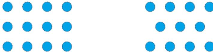
Abbildung 142 links linienartige Pinanordnung, rechts versetzte Pinanordnung
