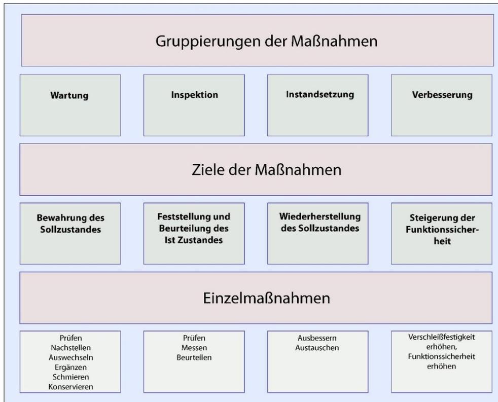
Abbildung 20: Instandhaltungsmaßnahmen nach DIN 31051(eigene Darstellung)
