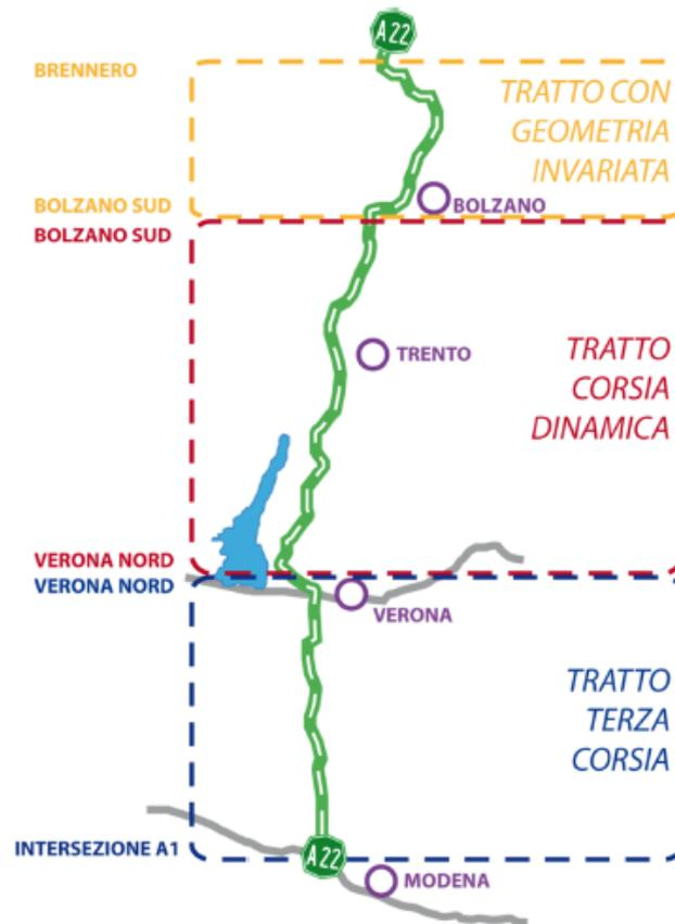
Abbildung 16: Brennerautobahn: Abschnitt ohne Veränderungen (gelb), Dynamische Spur (rot) und Dritte Spur (blau) (Brennerautobahn AG, 2016)
