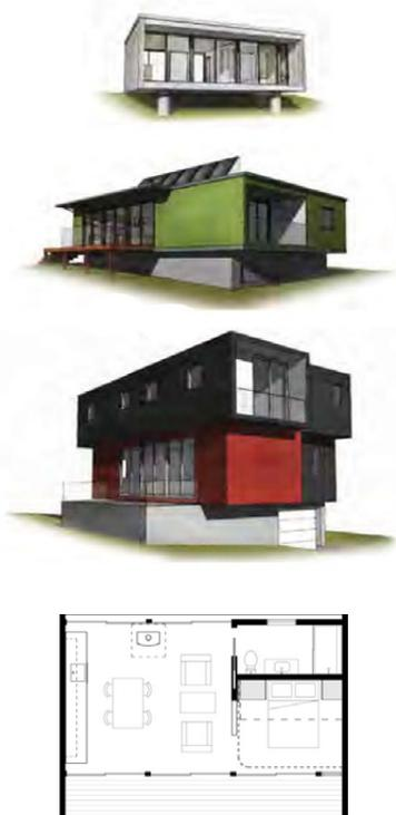
6.24 weehouse: Grundriss (einfaches Modul) und Kombinationsmöglichkeiten
