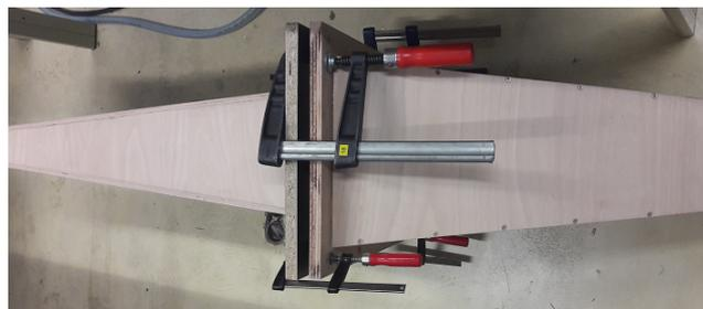
Abbildung 6.13: Aneinander geflanschte Trichter für die 4-Mikrofon-Messung
