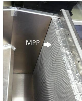
Abbildung 6.4: (a) Zweifach geschichtete MPP-Anordnung; (b) MPP-Platzierung im Umlenkbereich mit Abschluss der Ränder
