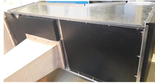
Abbildung 6.8: (a) Messkanäle an Trichter angeschlossen; (b) am Funktionsmuster befestigte Trichter
