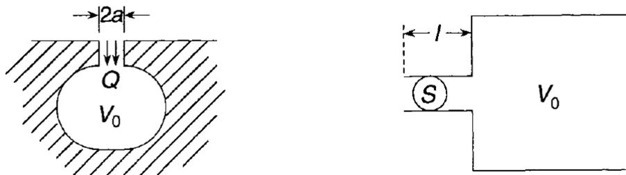
Abbildung 2.3: Schema eines Helmholtz-Resonators [1]
