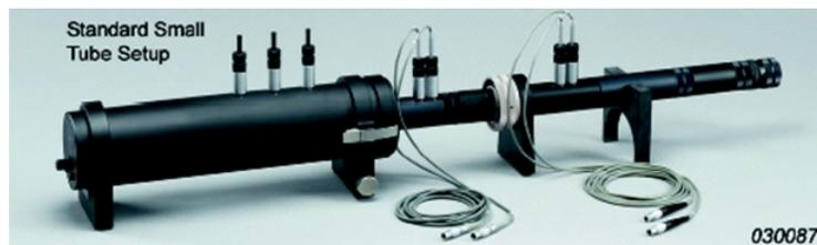
Abbildung 3.8: Verwendetes Transmissionsrohr für eine Grenzfrequenz von 6400 Hz; (Quelle: Brüel & Kjaer)
