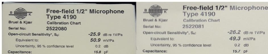
Abbildung 6.19: Verwendete Freifeld-Mikrophone
