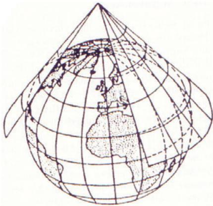
Abbildung 2.4: Prinzip der Kegelprojektion des Ptolemaios
