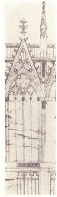
Abbildung 1.6: Detailplan vom Südturm Obergeschoss des Kölner Doms. Interessant ist, wie an zwei Stellen (im Druck schraffiert) die senkrecht zur Ebene verlaufenden Verbindungsbauteile geschnitten sind.
