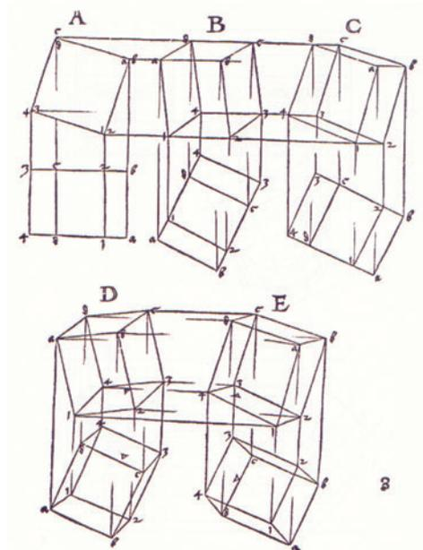
Abbildung 2.29: Schrittweise Konstruktion von Grund- und Aufriss eines Würfels in allgemeiner Lage
