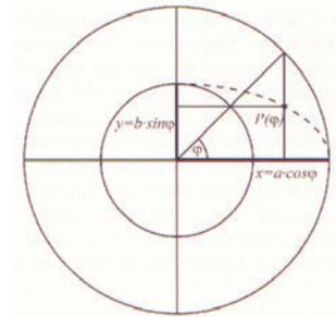
Abbildung 3.9: Ellipsenkonstruktion nach de La Hire
