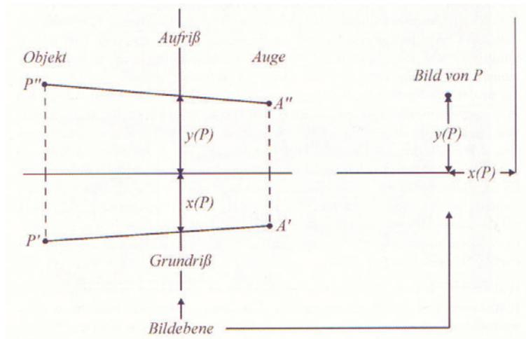
Abbildung 2.12: Schematische Darstellung der Durchschnittsmethode
