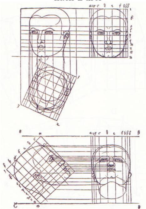
Abbildung 2.28: Anwendung zugeordneter Normalrisse zur Konstruktion verschiedener Ansichten eines Kopfes
