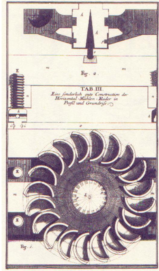
Abbildung 3.19: Wasserturbine im Grundriss bzw. Profilschnitt von L. C. Sturm (1718)
