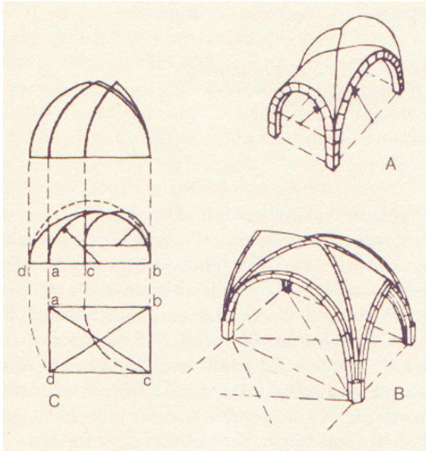
A) Romanische Überwölbung eines rechteckigen Joches mit gestelzter, d. h. überhöhter Bogenbasis über der kürzeren Spannweite. Diese unterschiedlichen Höhen der Bogenkämpfer (Basis) sind ästhetisch unbefriedigend.
