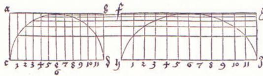
Abbildung 2.35: Dürers Konstruktion der Ellipse aus dem Kreis
