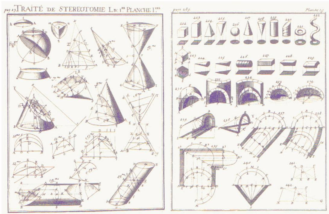
Abbildung 3.22: Frézier leitet die Gewölbeformen von den Rotationskörpern ab, die er in offensichtlich konstruierten Parallelperspektiven darstellt, ohne deren projektive Entstehung selbst zum Gegenstand seiner Untersuchungen zu machen.
