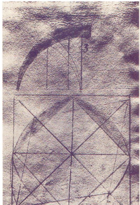
Abbildung 2.32: Ermittlung der kreisförmigen Bögen von Rippengewölben
