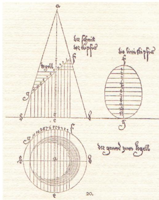
Abbildung 2.36: Dürers Ellipsenkonstruktion aus dem Kegel
