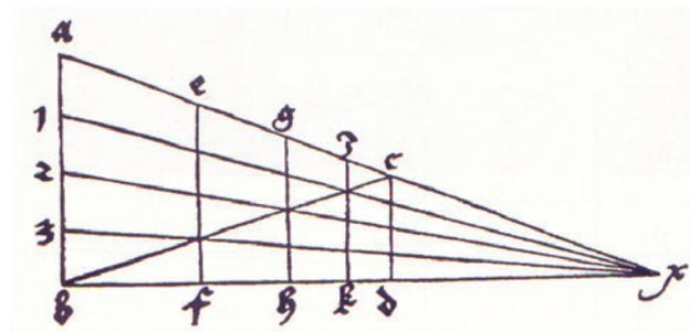
Abbildung 2.19: Konstruktion einer projektiven Skala nach Dürer
