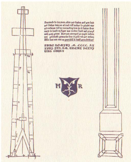
Abbildung 1.12: Roriczers Fialenkonstruktion
