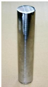
**Abbildung 1:** Warmgewalztes Stabstahlsegment "blank" (Durchmesser 40 mm)
