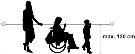
Abb.02 Bedien- und Greifhöhen für Rollstuhlfahrer\*innen und Kinder: 80 - 110 cm, max.120 cm. (Quelle: BMASK, Barriere:frei! Handbuch für barrierefreies Wohnen. S.11)
