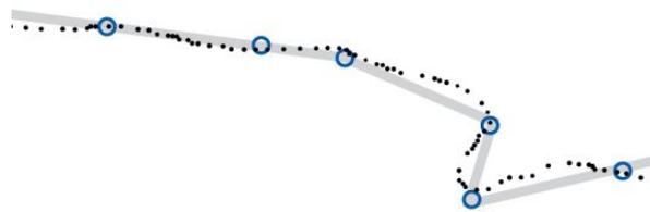
Abbildung 5.5: Skizze der .gpx-Elemente: die graue Strecke ist die Route, die größeren blauen Punkte die Waypoints und punktiert der Track. [Eigene Darstellung]
