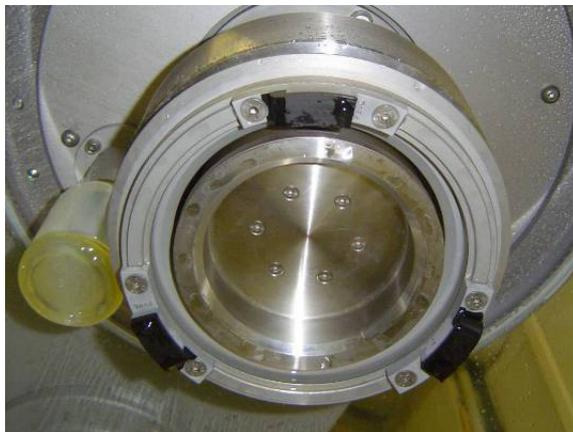
**Abbildung 4-5: Prüfkopf mit den drei Gleitschuhen [Foto: Kirchmaier]**
