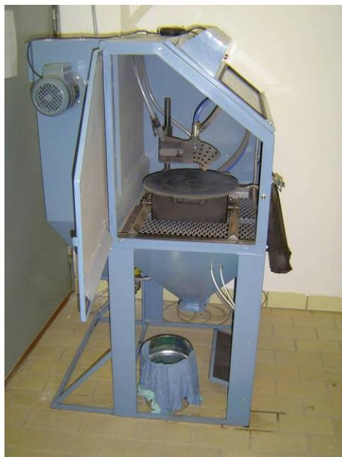
Abbildung 4-9: Sandstrahlkabine am Labor des ISTU [Foto: Kirchmaier]
