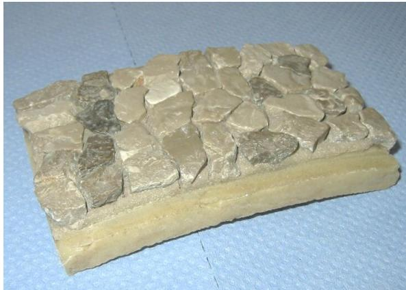
**Abbildung 3-8: Prüfkörper für die Bestimmung des PSV-Wertes [PFEILER, 2004]**
