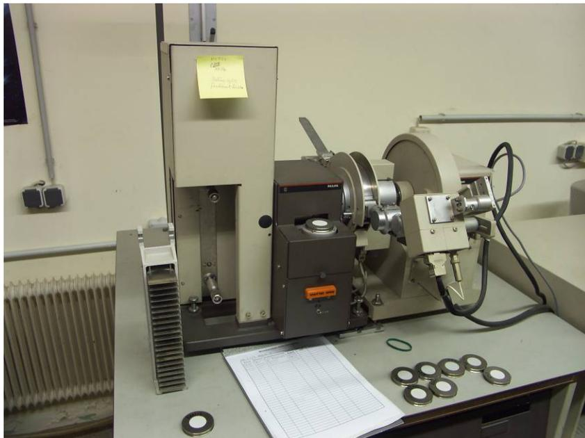
**Abbildung 6-6: Philips Röntgendiffraktometer PW 1710 des Institutes für angewandte Geologie an der BOKU Wien [Foto: Kirchmaier]**
