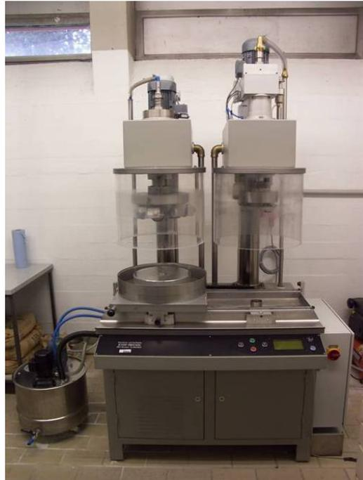
**Abbildung 4-1: Prüfanlage nach Wehner/Schulze des ISTU [Foto: Kirchmaier]**
