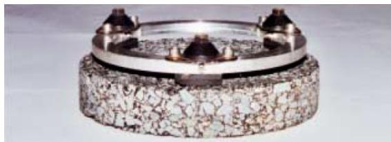
**Abbildung 4-6: Prinzip der Griffigkeitsmessung [HUSCHEK, 2002]**
