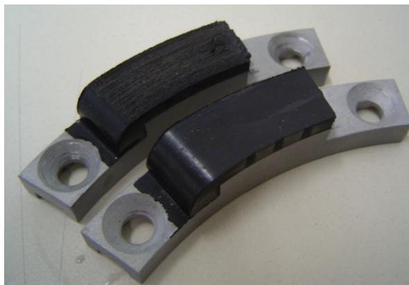
**Abbildung 4-7: Abgenutzter und neuer Prüfgummi [Foto: Kirchmaier]**
