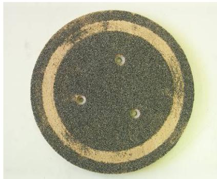
**Abbildung 4-10: Schadensbild einer unversiegelten Holzplatte nach der Griffigkeitsmessung [Foto: Kirchmaier]**
