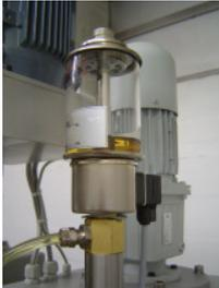
Die Prüfspindel wird vor jeder Prüfung beim Beschleunigen automatisch mit einem Tropfen Öl aus dem, oberhalb der Prüftraverse montierten, Spindelöler geschmiert. In den Tropföler darf nur gefiltertes, neues Spindelöl nachgefüllt werden.
