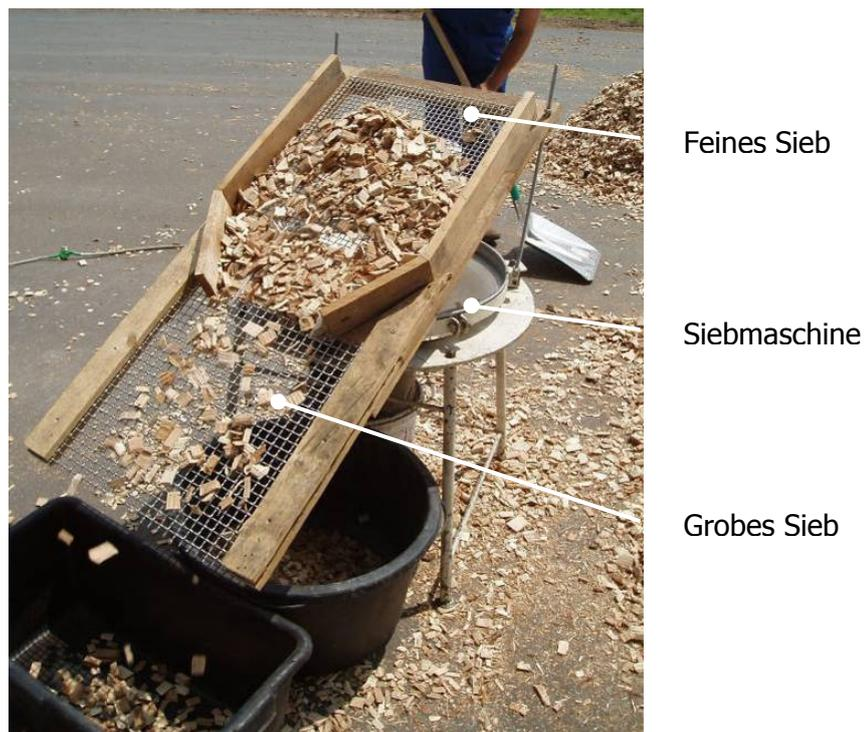
Abb. 30: Siebmaschine
