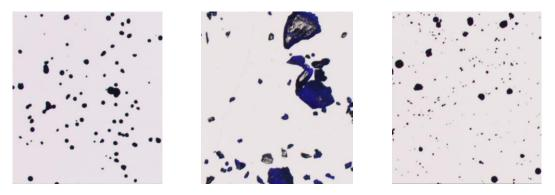
Abbildung 32: Mikroskopische Aufnahmen von Nektor (links), Quarzsand (Mitte) und DevCat (rechts)
