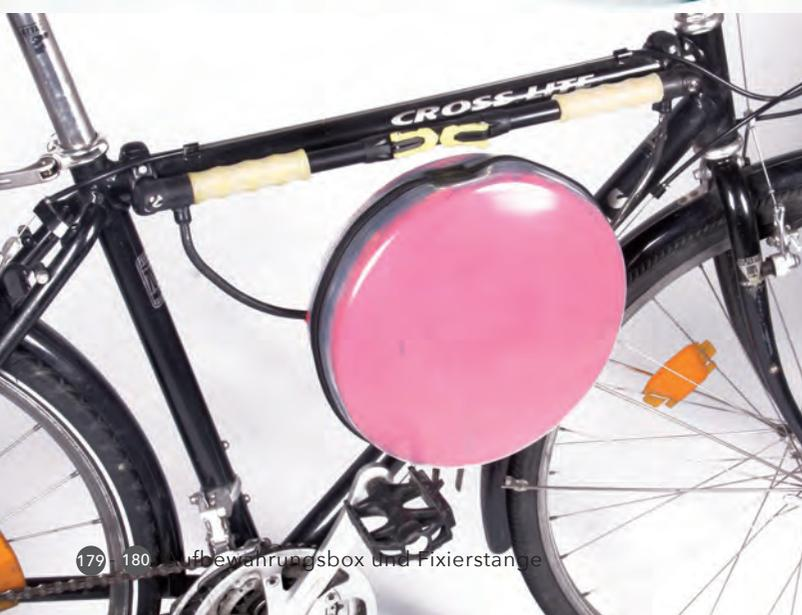
Der Prototyp der Fixierstange sowie die Aufbewahrungsbox wurden direkt in der D&E Company in Grieskirchen gefertigt und auf ihre Funktionsfähigkeit geprüft. Die Box sollte zwar erst hergestellt werden, wenn der fertige Prototyp eintrifft, jedoch wurde dies aufgrund der verspäteten Lieferung schon vorgezogen. Wie auf den Fotos zu sehen, passt sich die Fixierstange optimal dem Rahmen an und auch eine Probefahrt konnte mit Erfolg durchgeführt werden.
