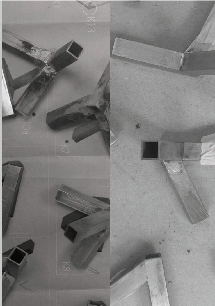
Fertig gelötete Knoten, vor und nach dem Reinigen u. Polieren
