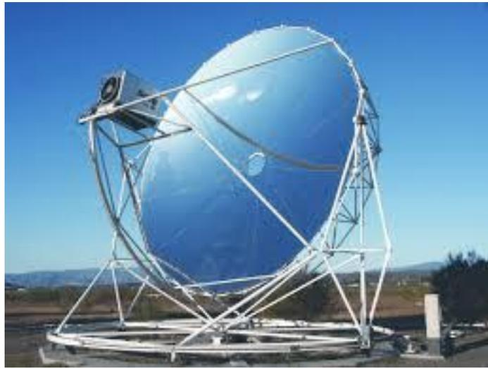
Abbildung 25 Dish-Stirling-Anlage [4]
