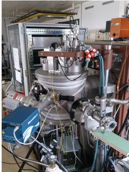
Abbildung 5.6: Foto des Rezipienten zur Beschichtung granularer Substrate
