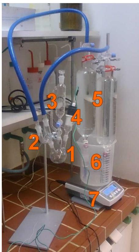
Abbildung 6.1: Aufbau des Hydrolyseexperiments: (1) Dreihalskolben, (2) Y-Verteiler, (3) Tropftrichter, (4) Temperaturmessung, (5) Messkolben, (6) Auffangbecher, (7) Waage
