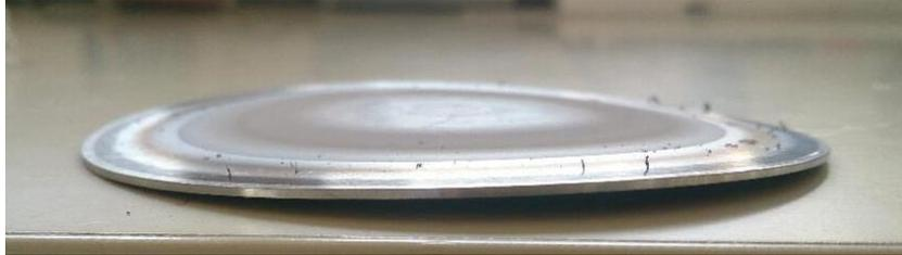
Abbildung 6.18: Durch die thermische Belastung beim Sputtern verbogenes Edelmetalltarget.
