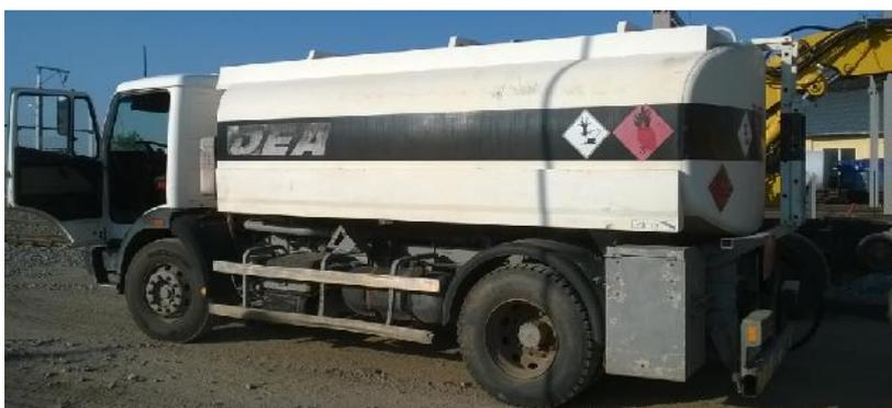
**Abbildung 55: Tankwagen mit Fassungsvermögen 10.400 l**
