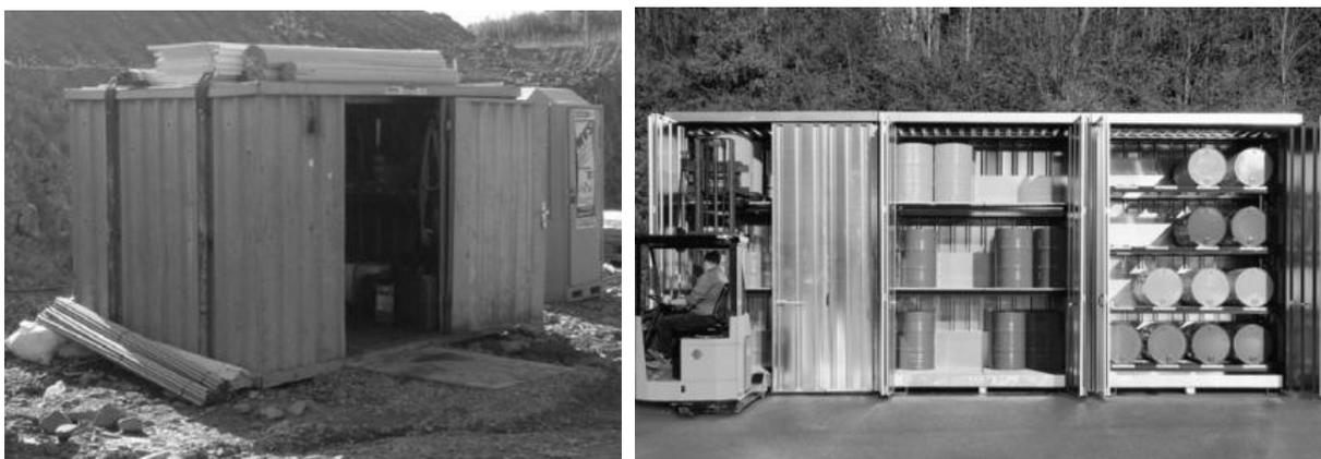
Abbildung 25: Lagercontainer für Bau- und Betriebsstoffe<sup>202</sup>
