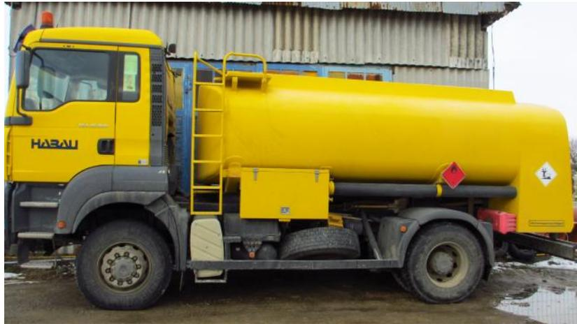
**Abbildung 44: Tankwagen MAN mit Fassungsvermögen 10.500 l**
