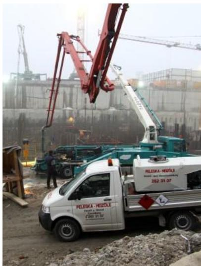
**Abbildung 20: Aufsatztank, montiert auf einem Transporter<sup>186</sup>**
