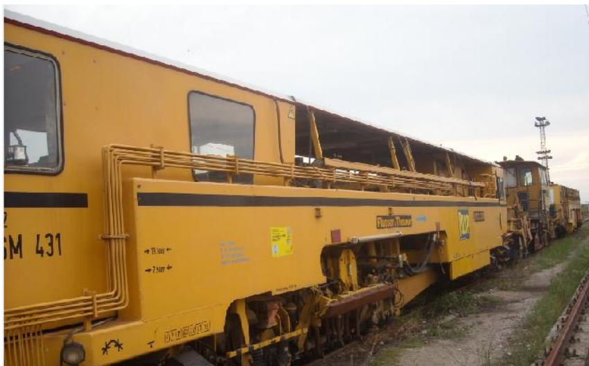
Abbildung 53: Gleisbau-Oberbaumaschine (hier eine Stopfmaschine)
