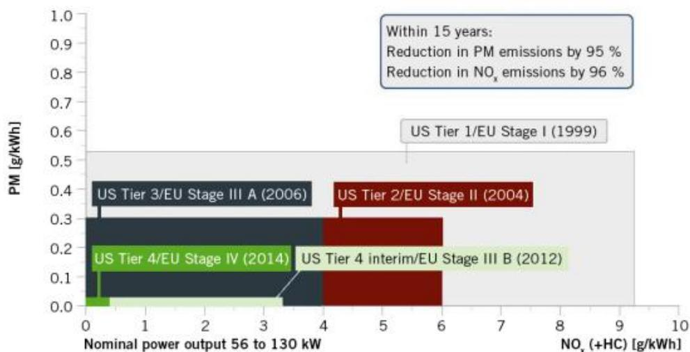
**Abbildung 9: Entwicklung der Emissionsgrenzwerte für Industriemotoren<sup>85</sup>**
