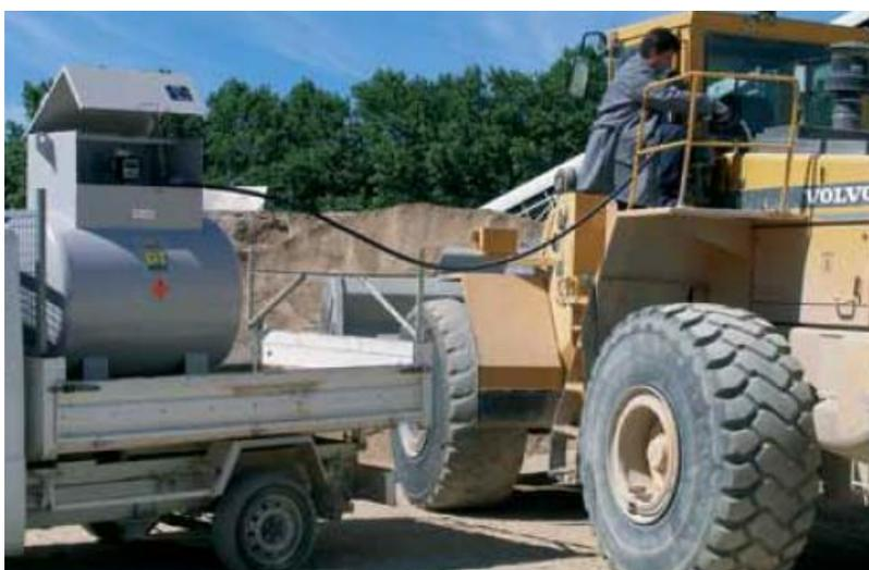
**Abbildung 19: Mobile Tankanlage bei Betankung einer Maschine<sup>184</sup>**
