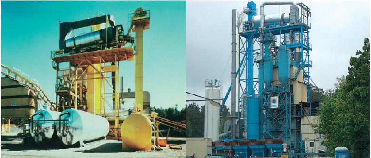
Abb.7 Paralleltrommel zur schonenden Trocknung und Erwärmung, links [5]
