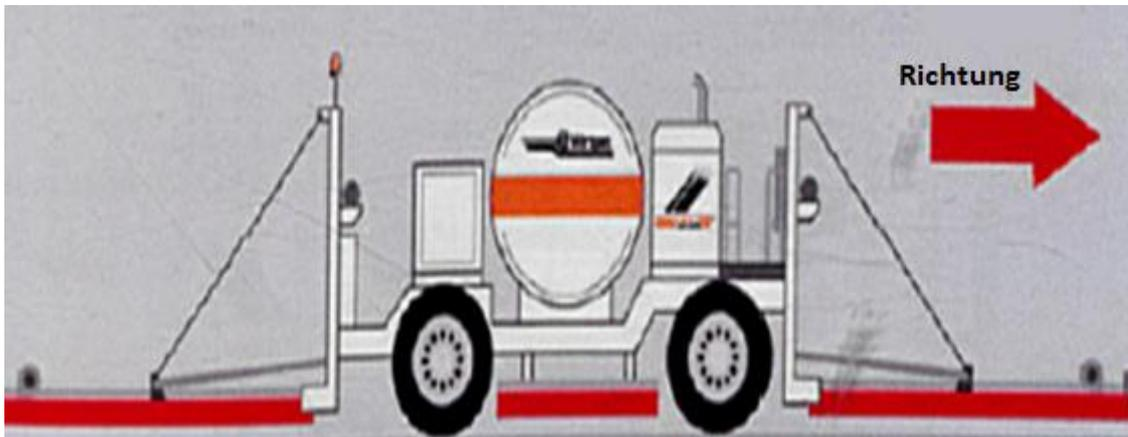
Abb. 12 Heißmaschine zur Erwärmung der bestehenden Asphaltbefestigung [7]
