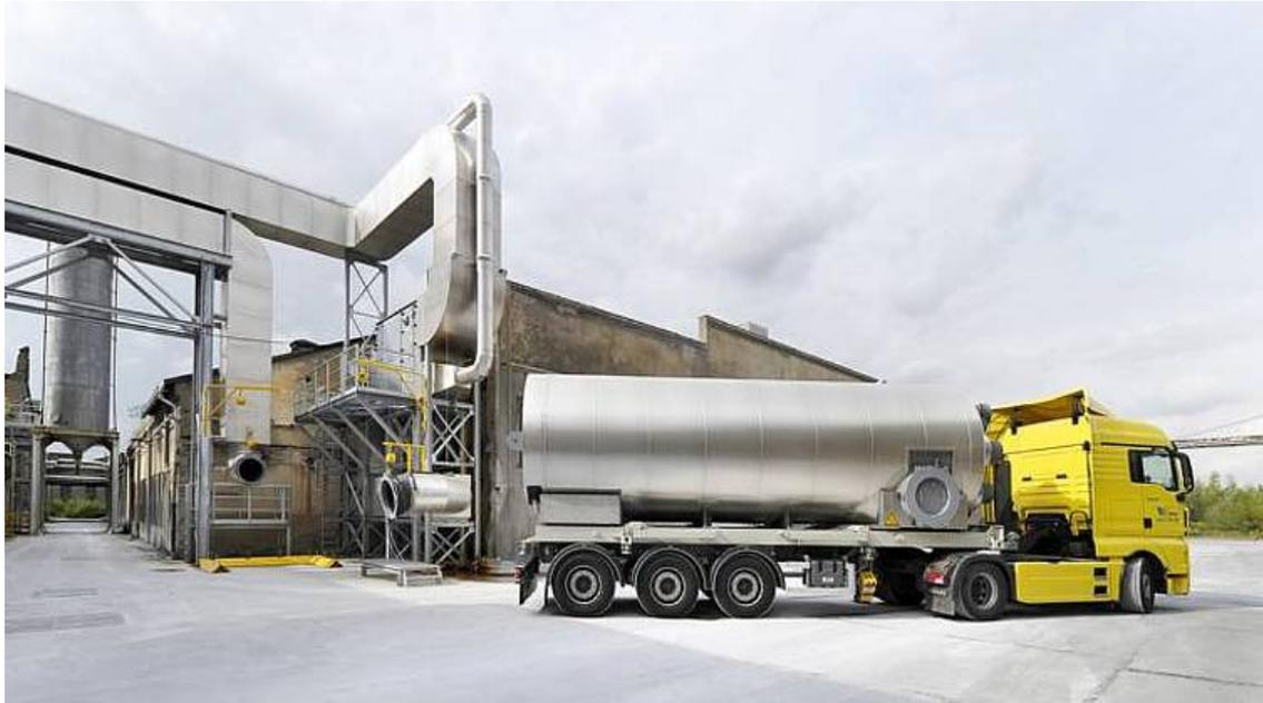
**Abbildung 5.1:** Ladestation und LKW zum Transport von Wärme mittels Zeolith [2]
