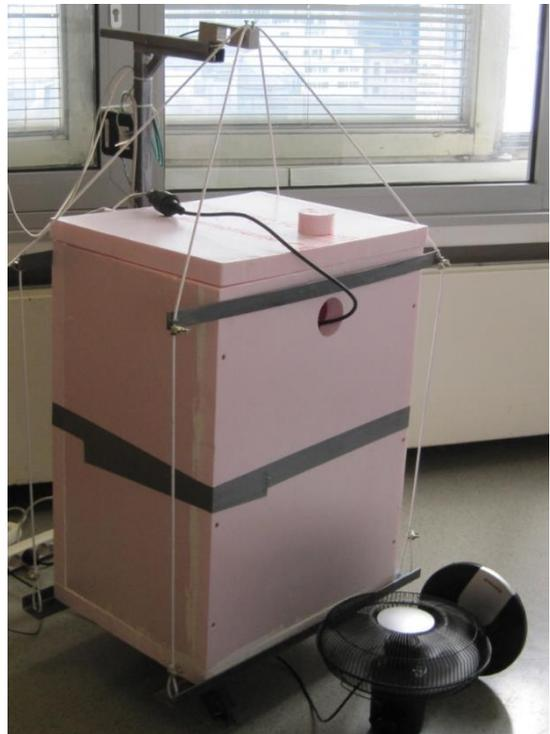
Abb. 7.7 Produktionseinheit mit Behälter und Ventilator, gut erkennbar ist die Hängevorrichtung mit Wiegeelement
