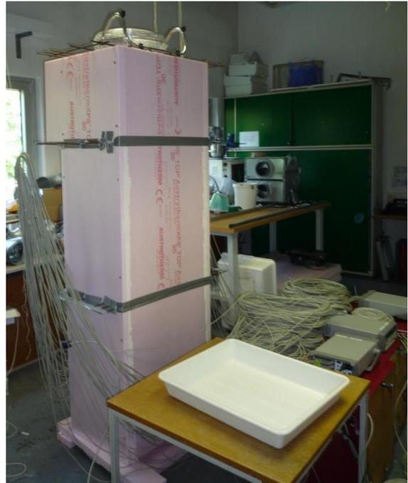
Abb. 7.6 Vorrichtung für Kalibrierung und Test der CO<sub>2</sub>-Sensoren
