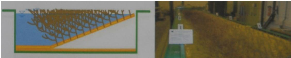
Vollständig bestockte Gerinneböschung (Versuchsserie VS2)
