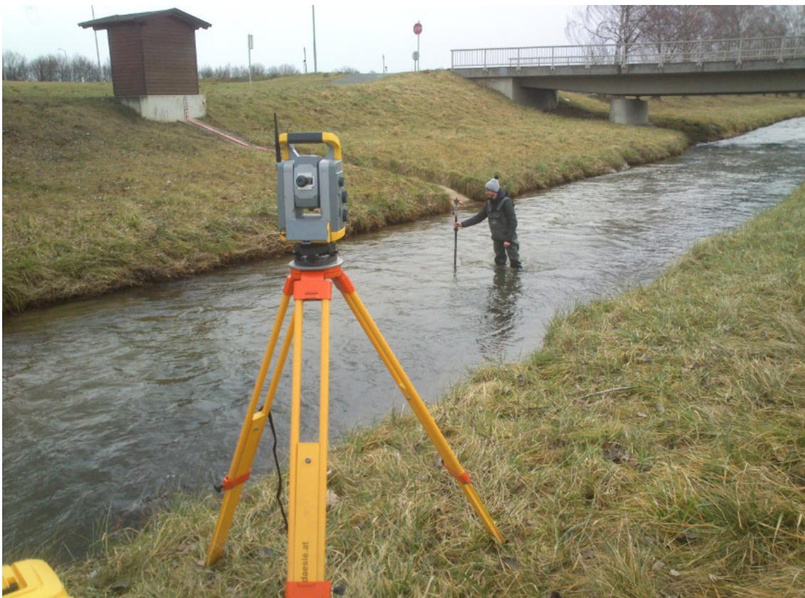
Abbildung 4.3: Vermessung des Sohlgefälles am 23. 01. 2015 (Pegel Pinka in Oberwart)
