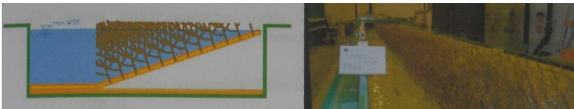
Vollständig bestockte Gerinneböschung – vertikale Trennfläche (Versuchsserie VS4)
