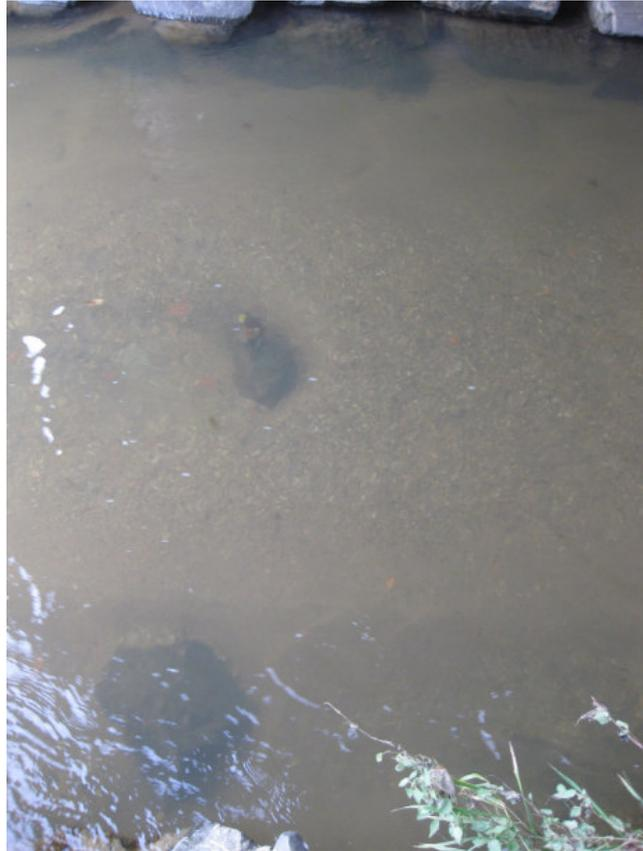
Abbildung 4.22: Zickenbach, Pegelstelle Siget i. d. Wart: Gewässersohle, Gewässerbreite = 3,9 m ca., sandiger Kies, vereinzelt größere Wasserbausteine –  $k_{S, \text{Sohle}} = 6 \text{ cm}$
