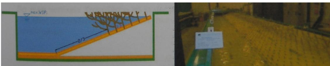
Gerinneböschung mit um 2/3 reduzierter Bestockung (Versuchsserie VS6)
