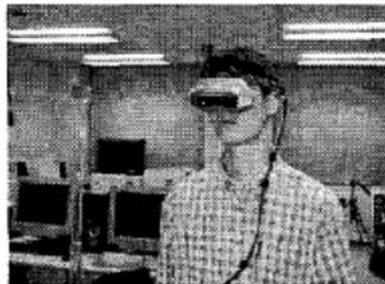
Abbildung 2: Video-See-Through HMD für eine Visualisierung von Avataren (Hachimura et al. 2004)
