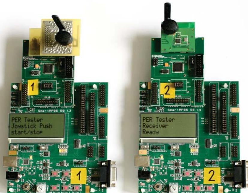
Abbildung 4.11: CC2520 Development Kit (links mit aufgestecktem Prototyp, rechts mit CC2520EM)
