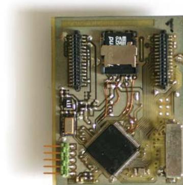
Abbildung 4.38: Prototyp des Datenspeichers
