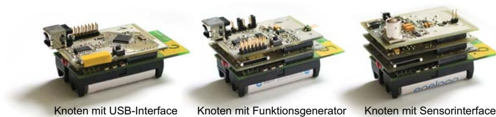
Abbildung 4.2: Assemblierte Knoten des Laborsystems
