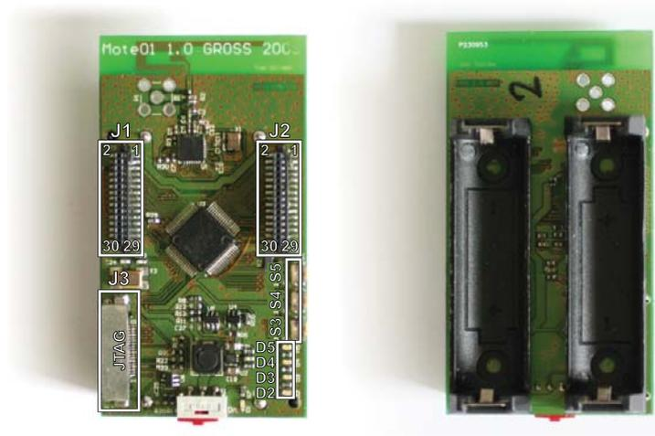
Abbildung D.1: Bedienelemente, Stecker und Buchsen des Basismoduls
