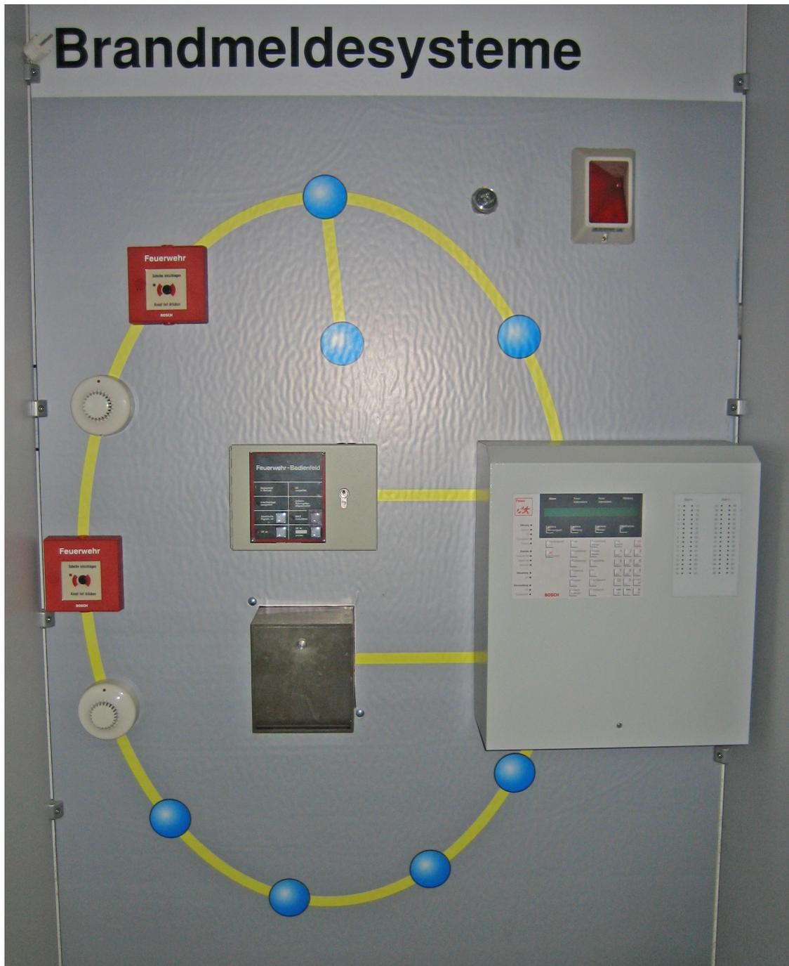
Abbildung 3.2: Schemantischer Aufbau einer Brandmeldezentrale, Quelle: Wikipedia
