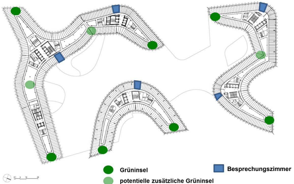
Abb. 45: Positionierung von Grüninseln und Besprechungszimmer auf Basis Ausbaupolierplan<sup>30</sup>
