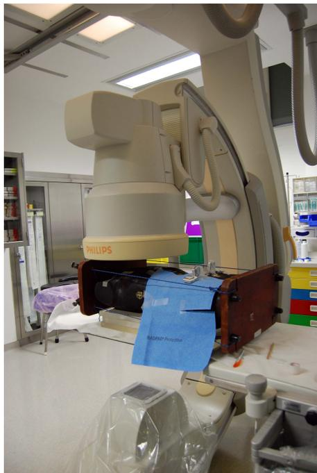
**Abb. 6.17:** Phantommessungen zur Wirkung der Strahlenschutzrichtungen Rad-Pad
