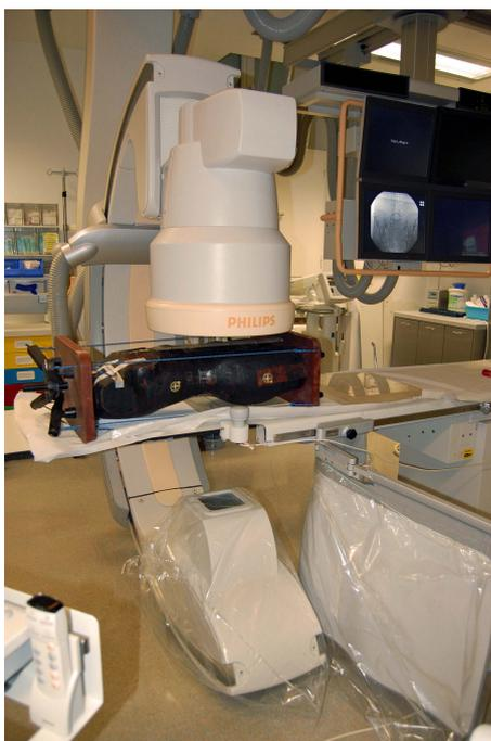
**Abb. 4.10:** Zur Simulation eines Patienten wurde ein Phantom verwendet. Um realitätsnahe Verhältnisse bzgl. Patientendicke zu erhalten wurde das Phantom mittels Plexiglasplatten verstärkt. Die Stärke der PMMA-Platten betrug jeweils 1 inch=2,54 cm.
