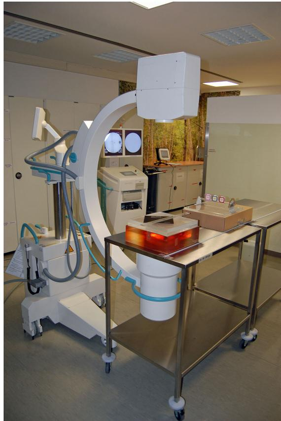
**Abb. 3.2:** Mobiler C-Bogen; Typ ZiehmVision der Firma ZiehmImaging inkl. Messaufbau
