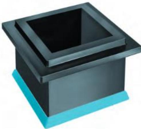
Abb. 25: Hybrid-Würfelform; Marke Kombi; Grundplatte aus Gusseisen und Mantel aus Kunststoff [41]
