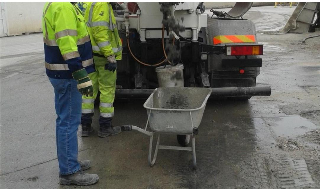
Abb. 22: Cemex-Labor Beton wird in die Scheibtruhnen eingefüllt
