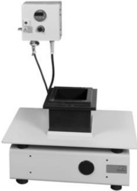
Abb. 27: Stück Rütteltisch mit Magnetspannvorrichtung, Zeitschaltuhr und regelbarer Drehzahl [42]
