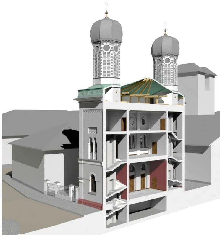
Abb. 156: 3D-Querschnitt - Stiegenhaus (ARCHICAD)
