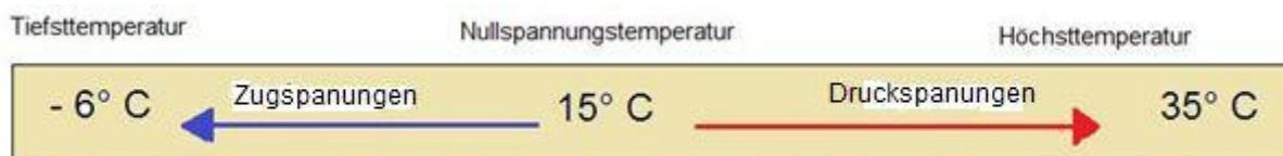
Abbildung 14: Wirkungsprinzip ab Nullspannungstemperatur [1]
