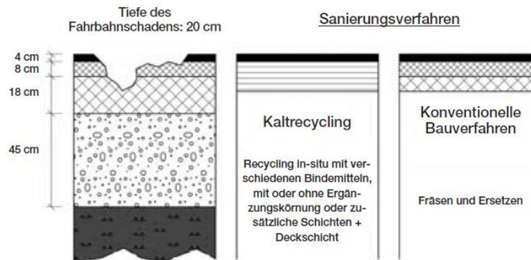
Abbildung 24: Erneuerung im Bereich des gebundenen Oberbaus<sup>113</sup>
