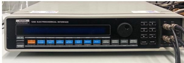
**Abbildung 6.5** – Messgerät Solartron 1286 – Potentiostat / Galvanostat.
