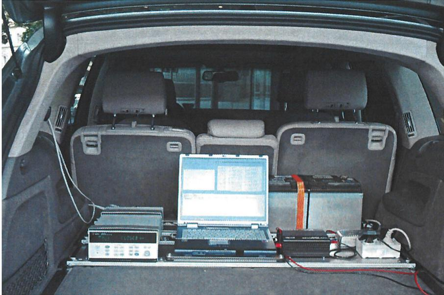
**Abbildung 6.14** – Messeinrichtung in einem Audi Q7. *Quelle: [59]*
