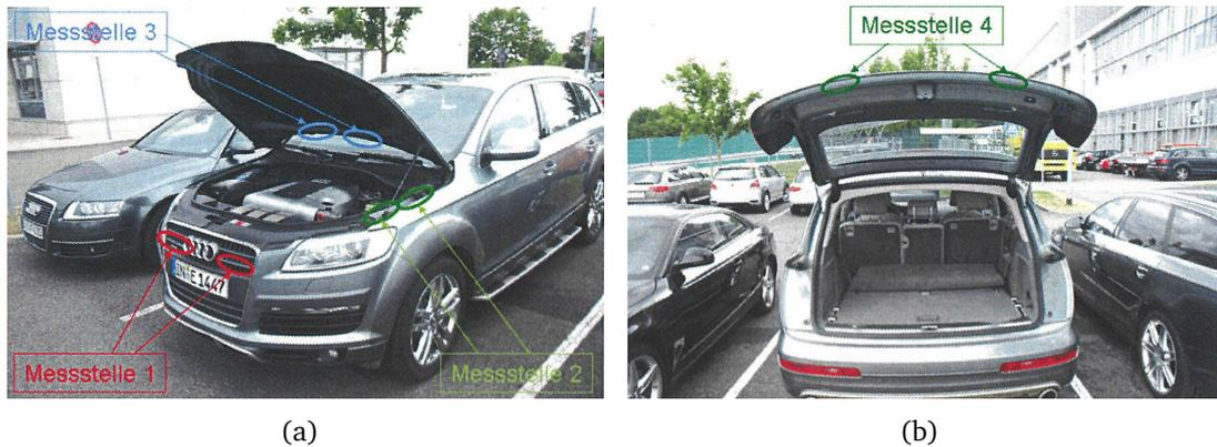
**Abbildung 6.13** – Korrosionsrelevante Messstellen im Audi Q7. *Quelle:* [59]
