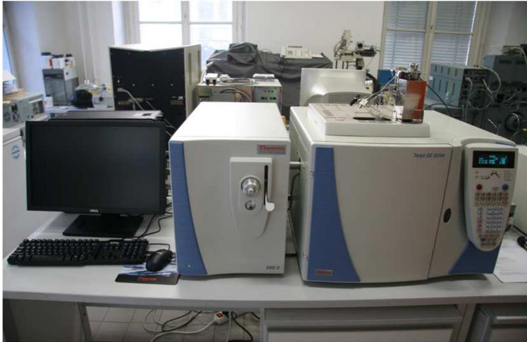
Abbildung 3.3: Pyrolyse-GC/MS-System; Pyrolyзатор: „Double-Shot Pyrolyzer PY-2020iD“; GC: „Thermo Trace GC Ultra“; MS: „Thermo DSQ II Single Quadrupole Mass Spectrometer“
