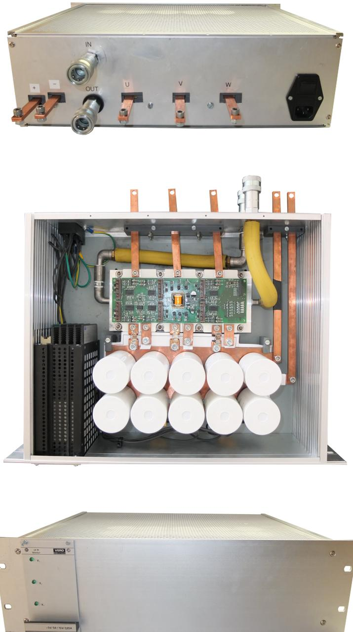
Abbildung 7.2: Stromrichter ohne Steuer- und Schnittstellenplatine und Bedienelementen
