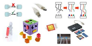
Figure 3.8 Examples for Poka-Yoke (Martisovic 2013: www.produktivne.sk)
