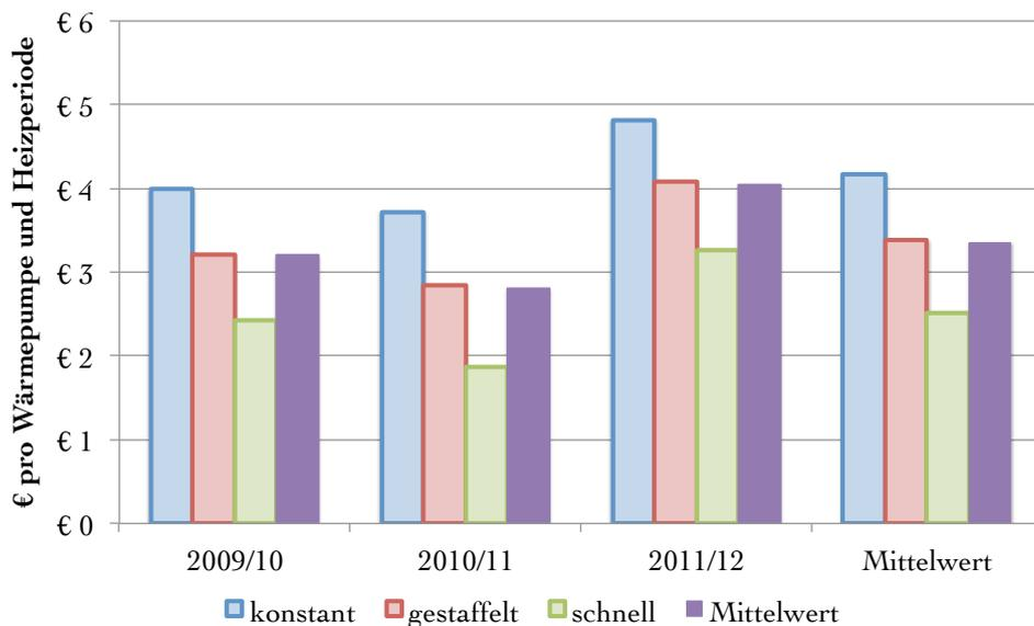
Abbildung 4.20: Unterbrechung 1 Stunde fix (Stunde h20): Vergleich der Erträge pro Heizperiode für die verschiedenen Nachladeszenarien
