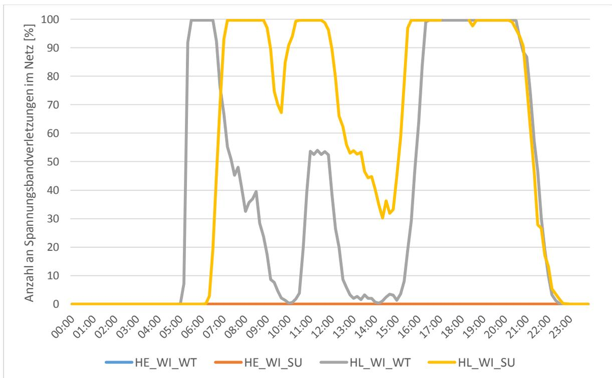
Abbildung 4-127: Anzahl an Spannungsbänderverletzungen im ruralen Netzgebiet im SOLL Zustand in Prozent, vorgegebenes Spannungsband:  $\pm 10\%$ , Szenario 2 und 3, Winter
