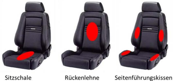
Abbildung 16: Position der Vibratoren im Autositz<sup>75</sup>
