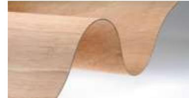
Abbildung 27 Biegesperrholz
