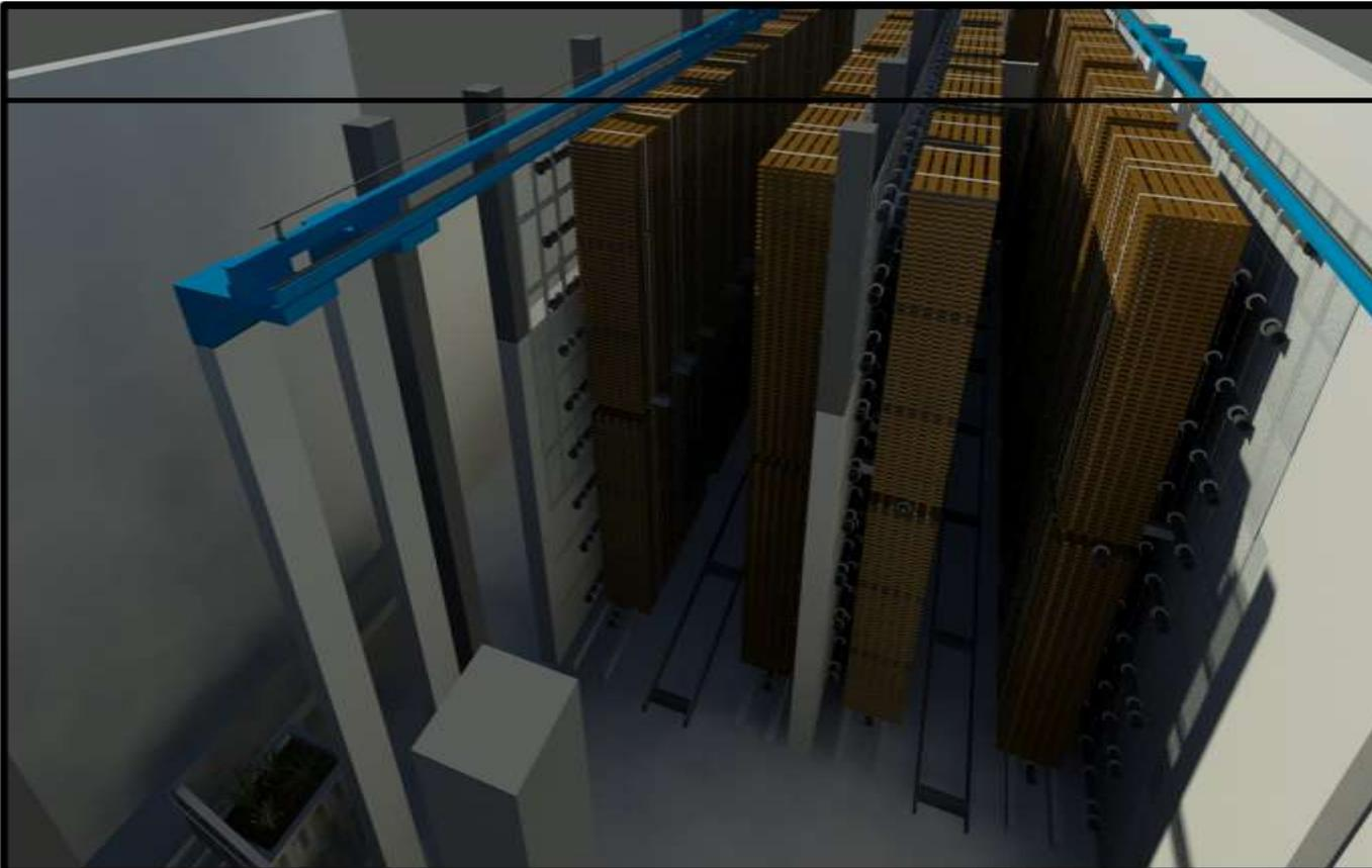
Auf den Wänden, die die Holzstapel trennen, sind Installationen für eine Luftströmung entworfen.
