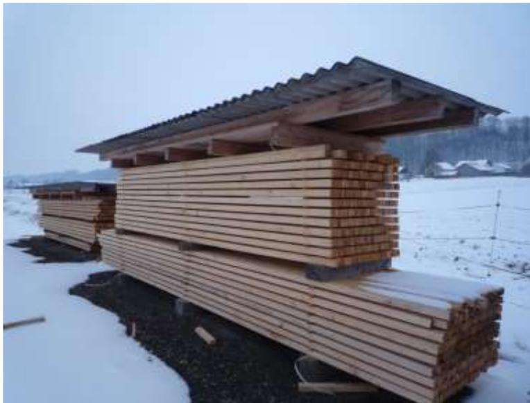
Abbildung 39 Freilufttrocknung
