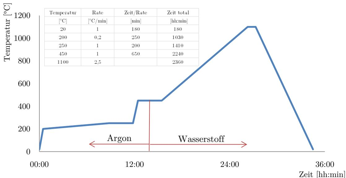
Abbildung 4-20 Zweites Sinterprofil
