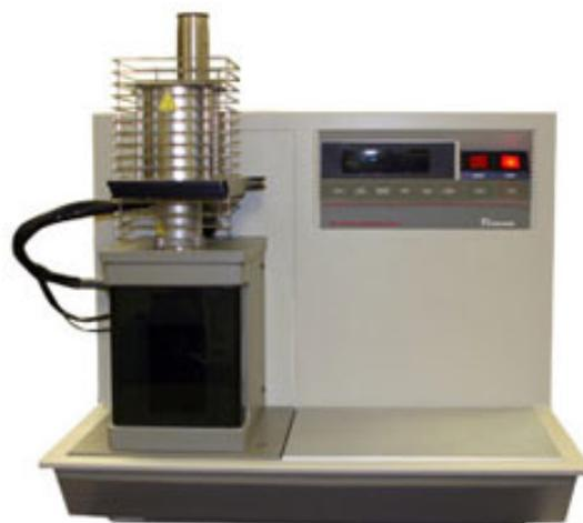
Abbildung 2-15 TMA Anlage 2940 TA-Instruments
