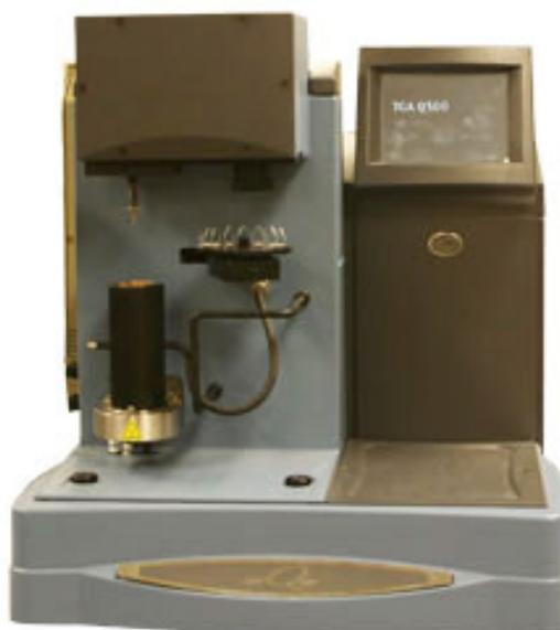
Abbildung 2-16 TGA-Messgerät
