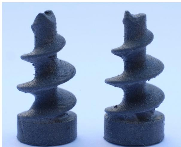
Abbildung 5-1 Bioschraube aus EOS-MS1-Pulver
