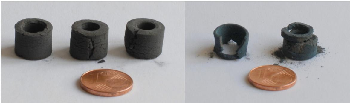
Abbildung 3-19 Zerstörung der Struktur beim Entbindern
